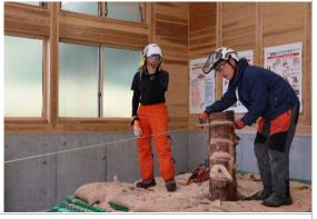
実際に受け口を伐り、倒れる方向のズレがど のくらいあるか、角度などを計測し注意点を 確認。
