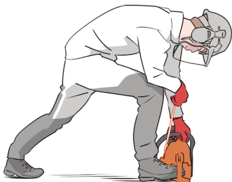
エンジンの始動は原則として地面に置いて行います
