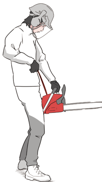
股に挟んで始動する場合は、左手で前ハンドルをしっかり押さえること
