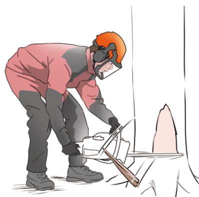
縦に薄く樹皮を切り取るフェイスカット
