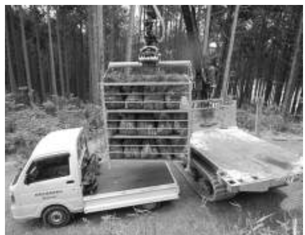
フォワーダでのラック積替作業
