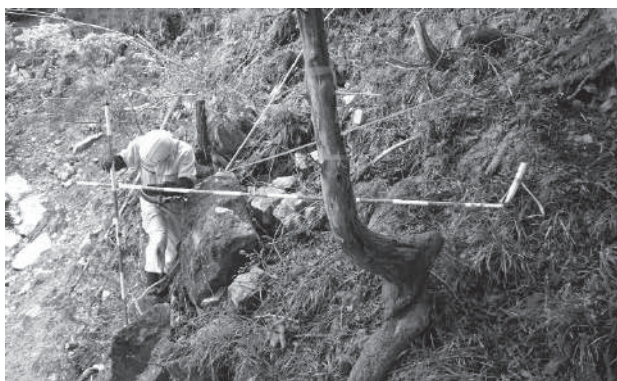
写真-1 従来の土量計測の様子
