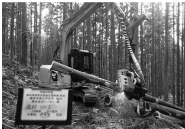
写真2 造材の様子（藤岡市大字高山）
