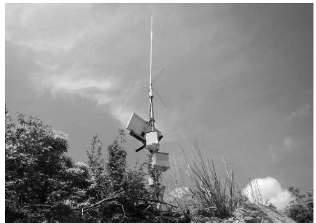
長距離無線式捕獲パトロールシステム（ほかパト）親機
