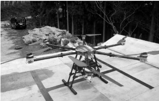
資材運搬用ドローン
