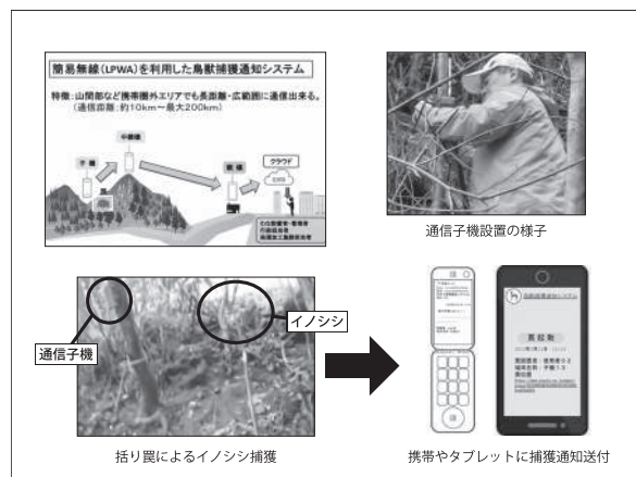
図4 簡易無線通信(LPWA)を利用した鳥獣捕獲通知システム
